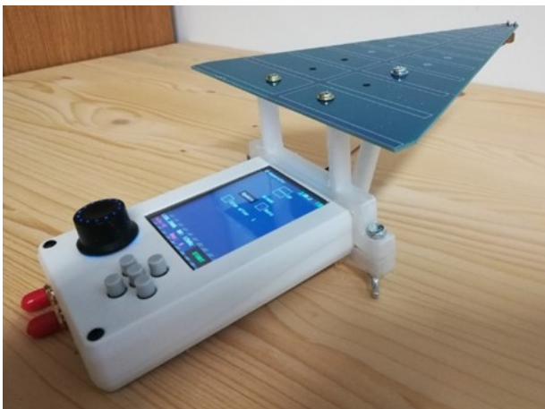
Nella foto l'antenna log periodica da 800MHz-6GHz collegata all'apparato tramite un supporto stampato con stampante 3D.
