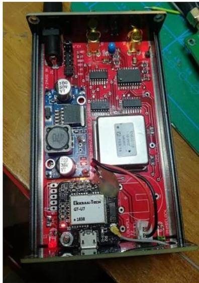
pensato di utilizzare un mixer attivo tipo INA81008 che riporta la frequenza di ricezione a 430 Mhz. L'oscillatore locale infatti genera una RF pari a 309 Mhz quando ci si trova in ricezione.
