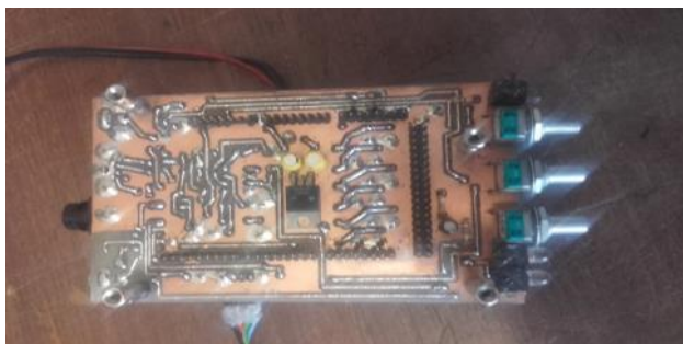
Board visto sotto lo stampato. Si vedono i connettori dove inserire l'Arduino mega
